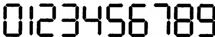
FIG. 3.2 - Représentation des chiffres par des digits.
